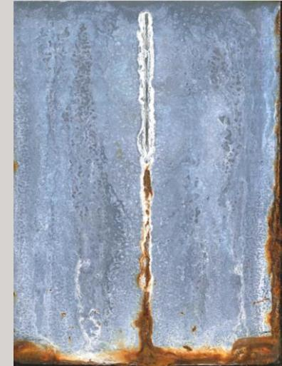
~ 80 µm 膜厚 | 塩水噴霧テスト 960 h 後 (DIN ISO 9227に基づく)
