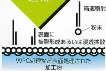
PIP (Powder Impact Plating) 処理は、WPC処理から派生した表面処理技術です。大気中において金属粉末や個体潤滑剤粉末を圧縮エアで高速噴射することによって、粉末を被処理材の表面に被膜形成あるいは浸透拡散することが可能です。この手法は、WPC処理や他の表面処理との複合処理をすることが可能なため、様々な製品への採用実績があります。
