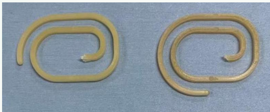
図2. スパイラルフロー長 : PPO (左) ; PPO+2% F-S1300 (右)
