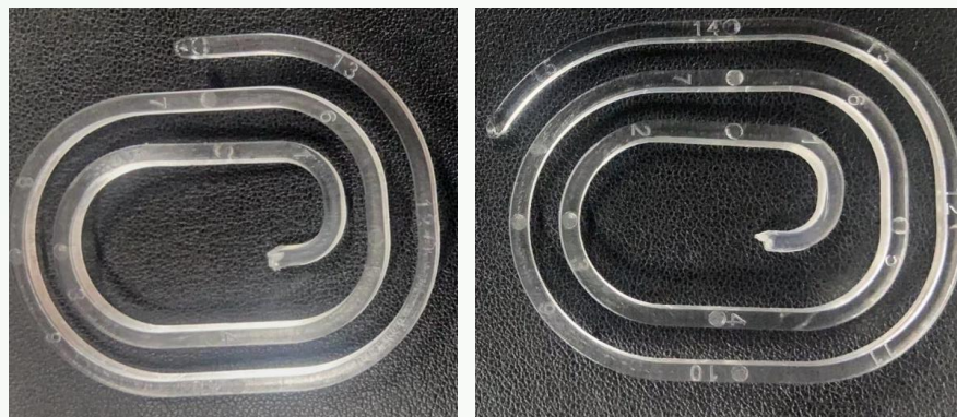
図1. スパイラルフロー長 : PC (左) ; PC+1% F-M510 (右)
