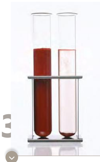
3 酸化鉄の分散度合い 65秒後 左：Dynasylan® 4148処理 右：未処理
