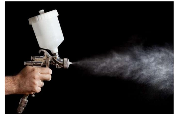
せん断力(かき混ぜる力などあらゆるケースでOK)が高い場合、粘度が低下するので、スプレーのノズルを通りやすくなります。
